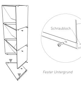
Auf festen Untergründen (z.B. Beton, Holz, Pflaster...) empfehlen wir die Befestigung mit unserer Basisplatte (optional erhältlich). Diese lässt sich mit 4 Schrauben (nicht im Lieferumfang enthalten) auf dem Untergrund verdübeln; alternativ kann man z.B. schwere Beton-Gehwegplatten o.Ä. zur Sicherung auflegen.
